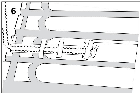
(Bilde 7) Skjær et lite spor ytterst i platen, slik at tilkoblingskabelen kan passere frem til platens ytterste spor.
