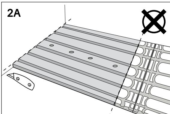
Våtrom Cable Board legges ikke i dusjsonen der fall skal sparkles mot sluket. Vi anbefaler i stedet Eboco Thermo Board (18 373 03) for dette arealet. Monter Thermo Board ifølge den medfølgende anvisningen. Kabelen legges i følge instruksjonene rett mot Thermo Board-platen.
