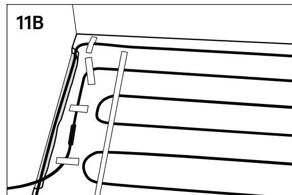
(Bild 12) När det redan ligger värmekabel i ytterspåren, skär ända ner till betonggolvet och lägg kabeln i det utskurna utrymmet.
