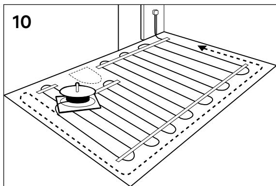
(Bilde 11A+B) Hvis du må passere forbi tilkoblingskabelen for å komme til et tomt ytterspor: Skjær bort 20 mm av isolerplaten langs veggens, helt ned til betonggulvet, og passer med varmekabelen der.
