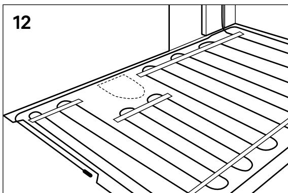
(Bild 13) Tejpa nya tejpremsor parallellt med de första tejpremsorna, ca 6 remsov/meter.
