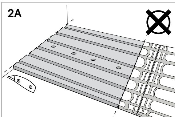
Våtrum Cable Board förläggs inte i duschezonen där fall ska spacklas mot golvbrunnen. Vi rekommenderar istället Eboco Thermo Board (89 601 60) för denna yta. Montera Thermo Board enligt medföljande anvisning. Kabeln läggs enligt instruktion direkt mot Thermo Board-skivan.
