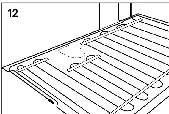
(Bilde 13) Fest nye taperemser parallelt med de første taperemsene, ca 6 remser/meter.
