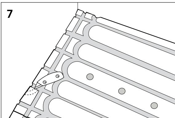
(Bild 8) Lägg anslutningskabeln i spåret och fortsätt till närmsta hörn. Fäst med tejp intill det breda spåret på skivans kortsida och låt tejprullen sitta kvar. Lägg kabeln i det näst yttersta spåret och fortsätt mot motsatt vägg.
