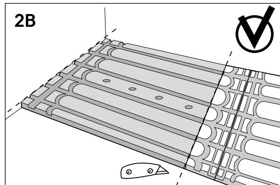
(Bilde 3) Skjær ut et spor til spiralslangen til føleren for gulvvarmetermostaten. Skjær deretter ut en firkant på 10x30 cm, men bare i 1 cm dybde. Her skal føleren plasseres senere.
