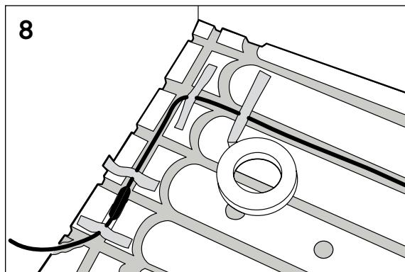
(Bilde 9) Snu i det nest ytterste, brede sporet på platens kortside. Tape rett innenfor det brede sporet, og la taperullen sitte på. Fortsett på samme måte til det er slutt på kabelen og alle spor unntatt yttersporene er fylt.
