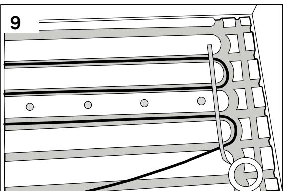
(Bild 10) Om du får kabel över när alla spår är fylda Lägg den i tomma ytterspår, i första hand mot ytterväggar.
