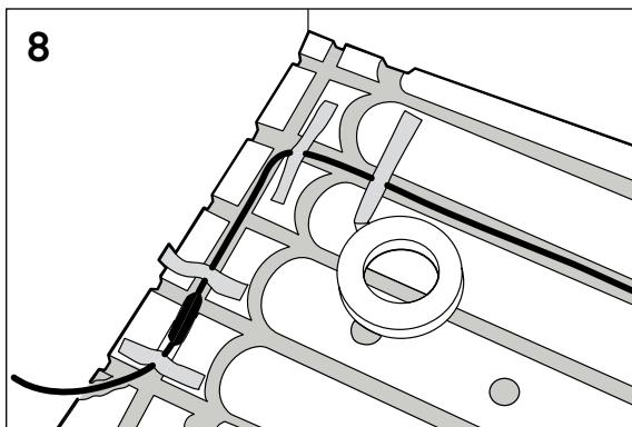
(Bild 9) Vänd i det näst yttersta, breda spåret på skivans kortsida. Tejp direkt innanför det breda spåret och låt tejprullen sitta kvar. Fortsätt likadant tills kabeln tar slut och alla spår utom ytterspåren är fylda.
